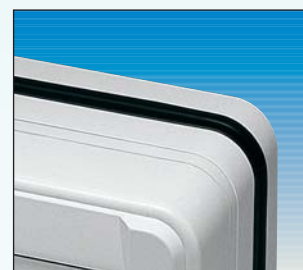
Per tutta la serie Ventil e Ventimatic, guarnizione in gomma per le parti a filo vetro con effetto sigillante e anti vibrante.
